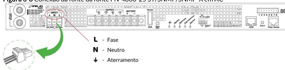
Figura 3-8 Conexão da fonte da fonte FN-4800-25 ST/SNMP/SNMP-X em AC
